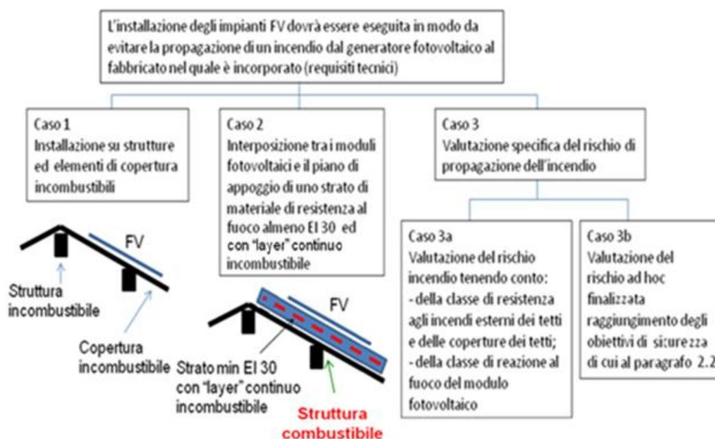
Figura 14 – Modalità di installazione di impianti BAPV
